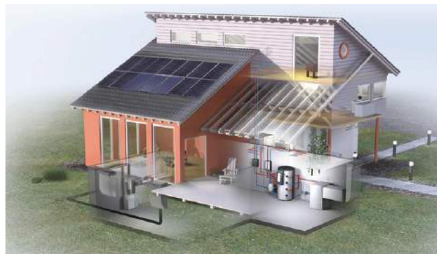
Abb. 135: Nachhaltiges Heizsystem (Wärmepumpe)
