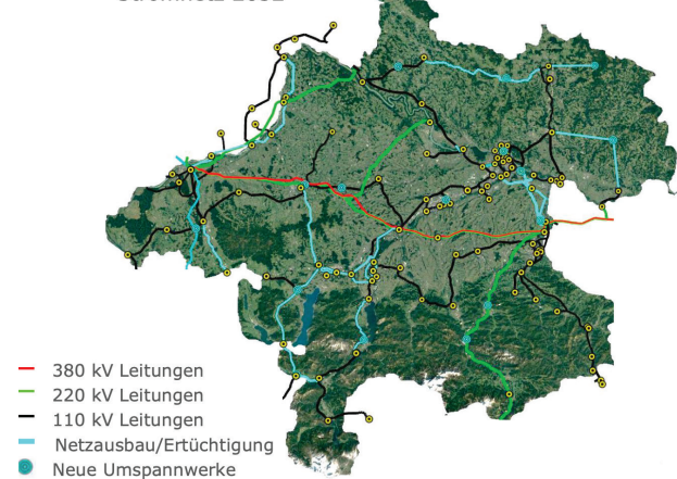
Abb 64: Hochspannungs Netz 2032 (Stromnetz-Masterplan Oberösterreich 2032 s.7)
